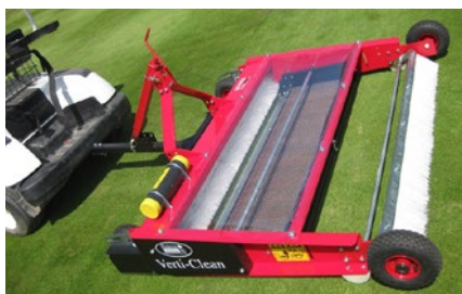
Čistič se sítí pro hrubé čištění
