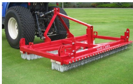
Kombinace kartáče a prutových bran
