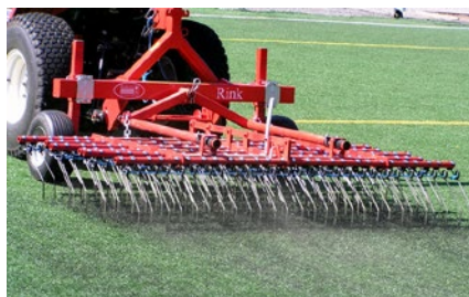
Prutové brány pro uvolnění granulátu
